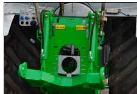
*Elevador L600 sobre COBRA (fijado por 4 ejes cónicos para hacer de éste un conjunto robusto)*
