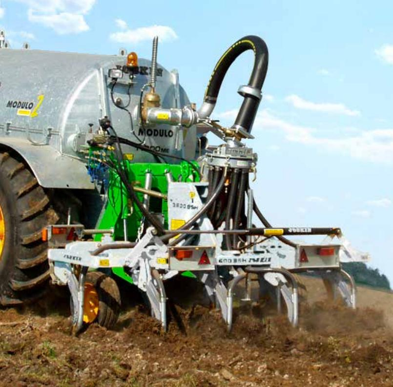
El inyector de cultivo TERRASOC está provisto de dientes rígidos con una distancia de 40 cm que traen rejas patas de oca ultra-llanas (24 cm de ancho) con bulón de seguridad. La forma de los dientes y la escotadura ancha aseguran una fluidez muy buena del purín. Las ventajas de este sistema son :
