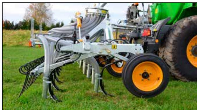
TERRAFLEX/2 provisto de una grada niveladora
