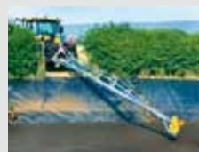
Batidoras de estiércol reforzadas para depósitos abiertos y lagunas
