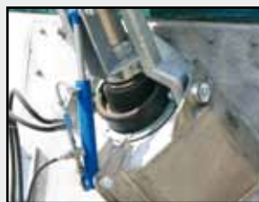
Manguito de goma (segundo manguito de goma interior, para doble seguridad en opción)
