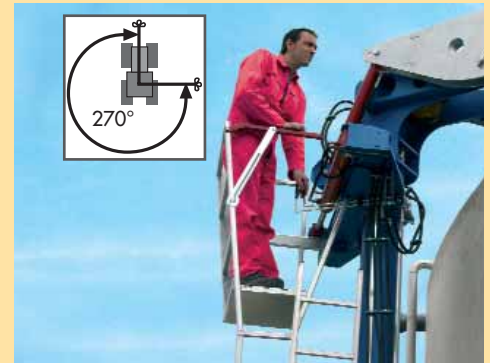
Barra girable hidráulicamente hasta 270°, torre telescópica, hidráulicamente hasta 6 m
