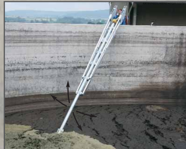
RECK batidora de toma de fuerza MAMUT-TITAN para depósitos de torre
