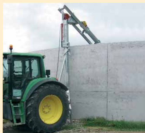
batidora de torre MAMUT en acción
