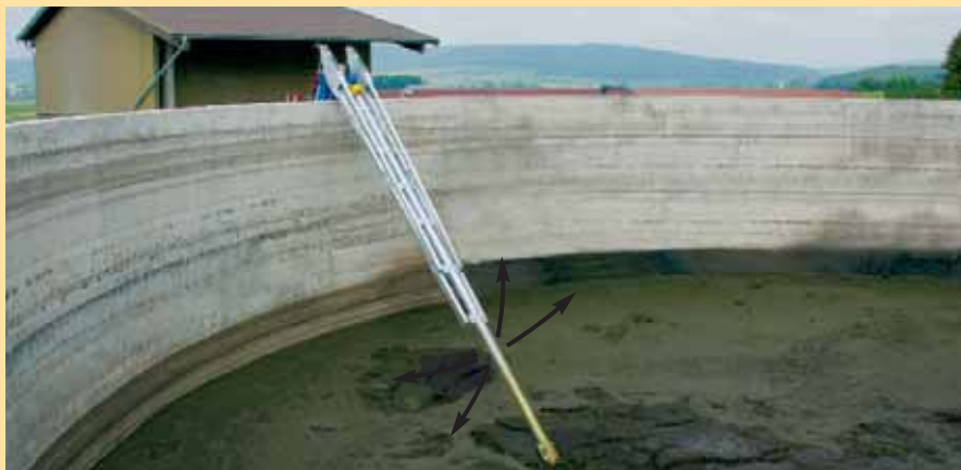
Batidora de toma de fuerza RECK MAMUT-TITAN para depósitos de torre con barra de agitación girable en acción
