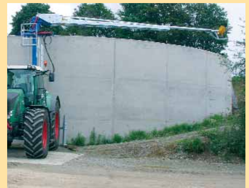
Batidora MAMUT-TITAN para depósitos de torre al girar
