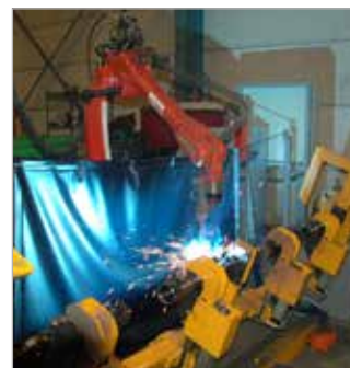
Robot de soldadura
