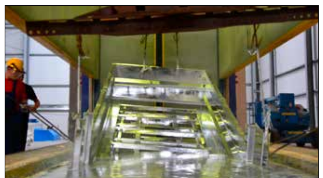
Galvanización en caliente (interior y exterior)
