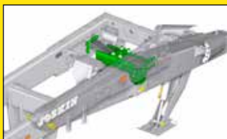
Suspensión de la lanza con láminas parabólicas
