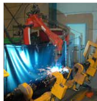
Robot de soldadura
